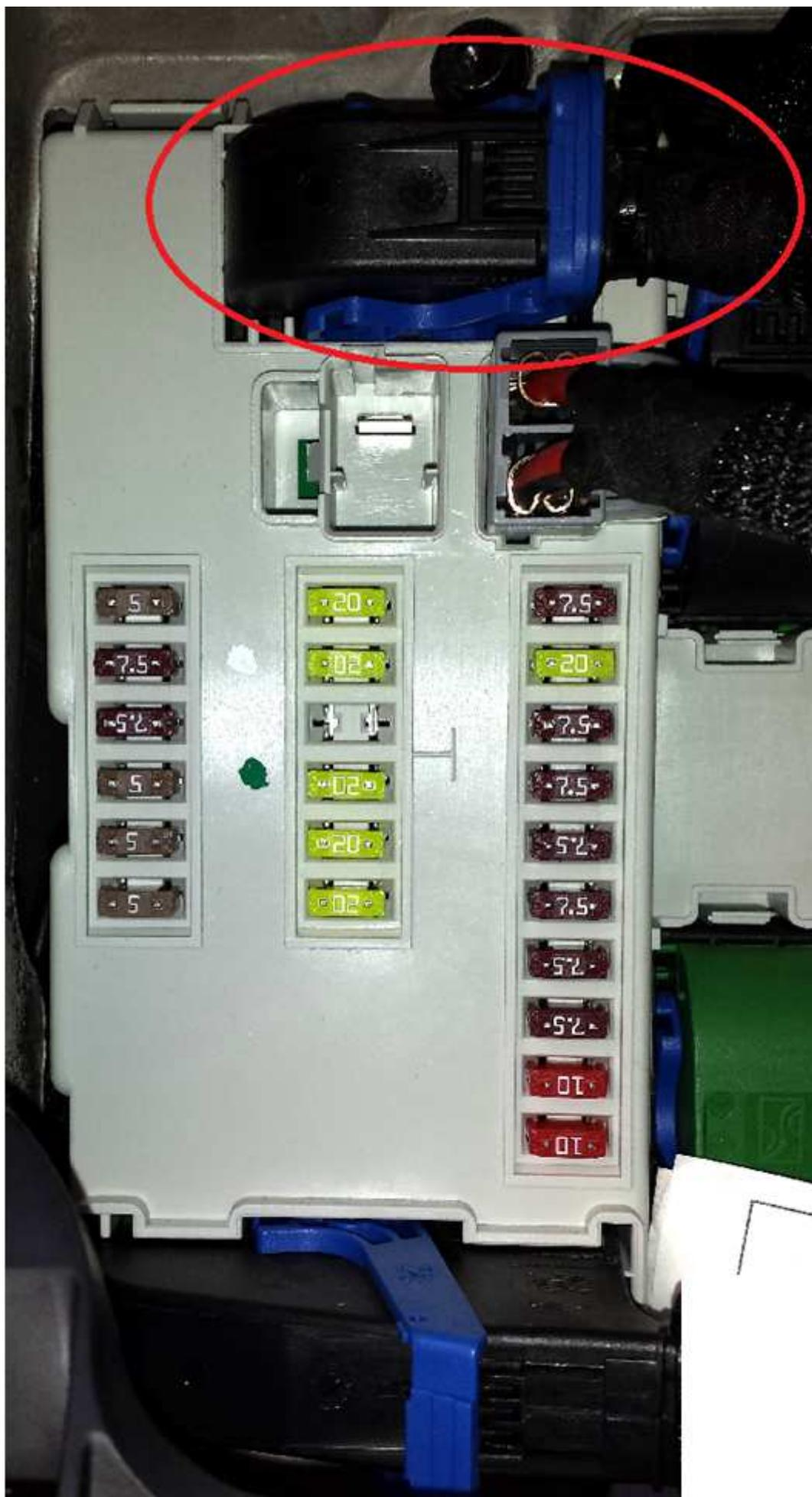
Tagliate la fascetta di plastica nera e con un cacciavite fate leva sul dentino di plastica per sfilare la scocca esterna, in modo da ritrovarvi di fronte il connettore "nudo"
