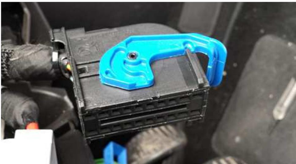
Ecco un ulteriore dettaglio del connettore C montato sul Body Computer. E' situato in alto.
