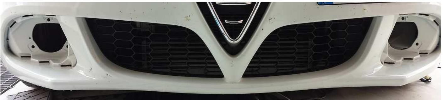
Facciamo fuoriuscire l'ultima parte di cablaggio originale (quella nel tubo corrugato di plastica) dai buchi del paraurti, colleghiamo i connettori ai fendinebbia e montiamoli nei loro alloggiamenti.
