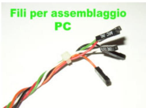
Con questi cavetti avremo il vantaggio di collegarci ai Pin utili senza andare incontro a problemi di smontaggio e saldature. Il risultato sarà questo:
