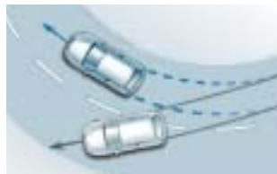
L' ABS con EBD impedisce il bloccaggio delle ruote in frenata. Insieme ai sistemi EVA e HBA dà più forza alla frenata d'emergenza.
