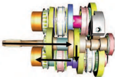
Ingranamento 2 a velocità
