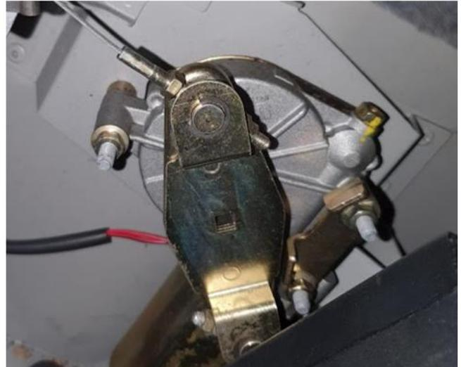
(il pezzo di mandrino rotto con il dado / the broken spindle with the nut)
