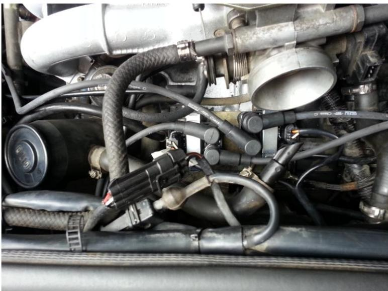
Togliamo i cavi candele ed il cavo di alimentazione della bobina
