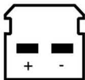
Vista da davanti del connettore a 2 pin*
