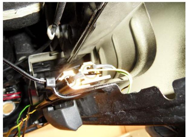
Ho inserito i 3 fili in un pezzo di termo restringente lungo abbastanza per arrivare fino alla parte superiore del tappo che abbiamo tolto all'inizio per accedere alle lampade. Questo per rendere i fili quasi invisibili e soprattutto isolati.
