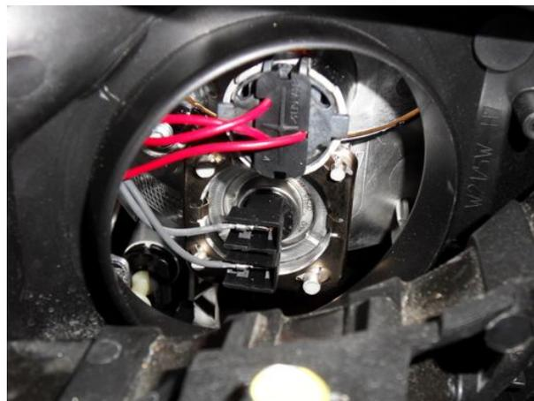
Rimuovere la lampada e con un cacciavite spaccato fine rimuovere con attenzione il coperchio in plastica che copre i connettori e blocca i fili in posizione delle luci diurne.
