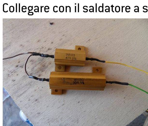
Collegare con il saldatore a stagno un filo ad un capo di una resistenza e ponticellare il collegamento ad un capo dell'altra resistenza, in modo da avere un filo collegato ad entrambi i resistori che fungerà da nostro Negativo (dato che è comune anche sul connettore della lampada), assicurandovi di isolare i collegamenti appena fatti con del
