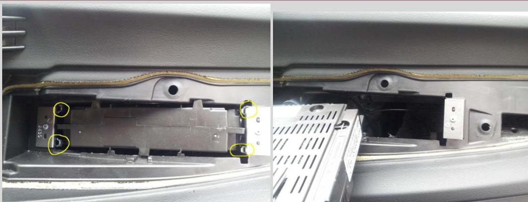
Ora possiamo posizionare il radionav nel suo vano facendo passare il cavo di collegamento giu insieme agli altri cavi e fissare il tutto con le due viti svitare all'inizio dal cassetto portaoggetti ricordandoci di non chiudere ancora con il coperchio per i motivi detti in precedenza.
