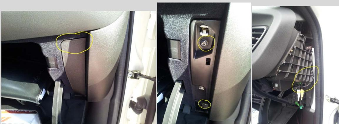
A questo punto facciamo passare il cavo lungo la plancia per facilitare le operazione andremo a sfilare il modulo blu&me così da poter infilare la mano e prendere il cavo che con l'altra mano facciamo passare dal pannello laterale come cerchiato nella foto precedente.
