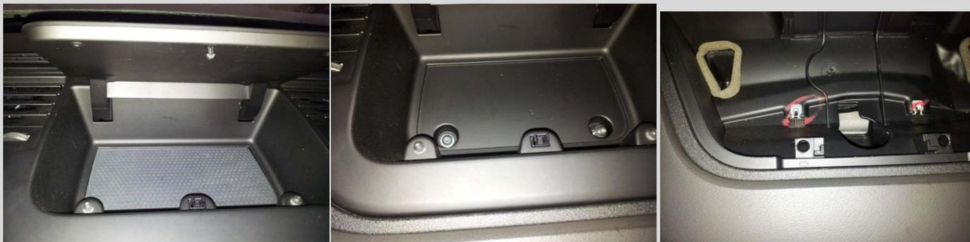
Guardando l'ultima immagine bisogna levare le placchette metalliche cerchiare in rosso dove si avvitano le viti del vano portaoggetti e posizionarli nei due buchi posti più in alto dove si andrà poi ad avvitare il radionav ottenendo il risultato in figura:
