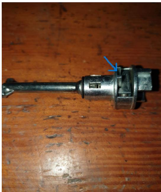
Ecco, ora io non so cosa intendesse dire supermario con “ Inserendo un cacciavite piccolo nella parte opposta. “ Io sono riuscito inserendo il cacciavite piccolo dove indica la freccia e ho fatto leva. La parte piatta ora è in posizione bloccata, liberando l'accesso al nuovo cilindretto. (Foto sotto)
