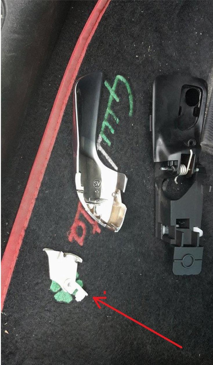
8) ruotando il pannello dovreste vedere il blocco nero di plastica che supporta la maniglia. Svasare con cautela i punti indicati con una punta da 12 o maggiore per liberare i perni del blocco plastico che sono fusi a pressione
