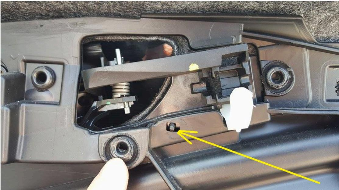
10) con il supporto plastico in mano dovrete essere in questa situazione con il perno della maniglia ancora in posizione e la molla ancora infilata nel perno
