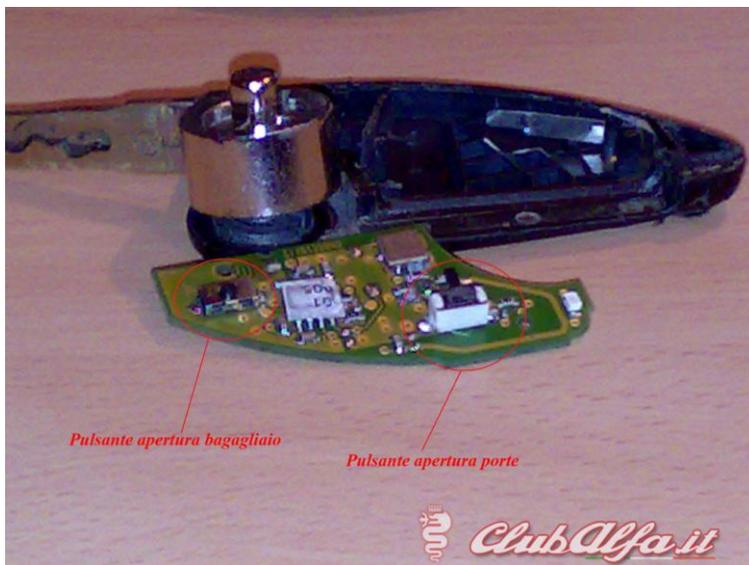
8. Ho "rasato" il piccolo distanziatore che andava a premere sullo switch, causa altezza elevata dello switch che ho saldato...
