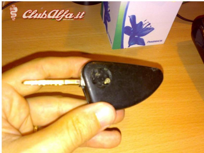
3. Portare la vite indicata in figura dalla posizione "LOCK" (bloccato) in quella "UNLOCK" (sbloccato) e togliere il supporto batteria...
