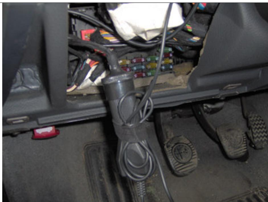
MENTRE IL CAVO DI ALIMENTAZIONE E' STATO COLLEGATO AD UNA PRESA PER L'ACCENDISIGARI VOLANTE (PER EVITARE DI TAGLIARE IL CAVO E PERDERE LA GARANZIA DEL PRODOTTO), IL CAVO DELL'ANTENNA E' STATO INSERITO ALLA BASE DEL MONTANTE ANTERIORE SINISTRO
