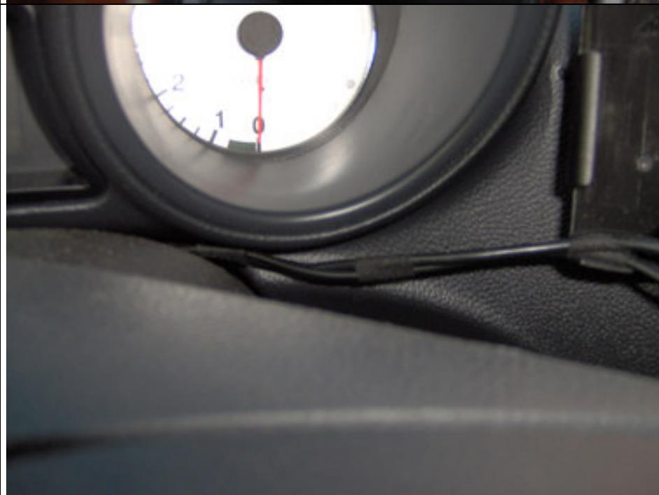
I CAVI (DI ALIMENTAZIONE E DELL'ANTENNA) SONO STATI FATTI PASSARE DIETRO ALLO STERZO, PROPRIO SUBITO SOTTO LA STRUMENTAZIONE
