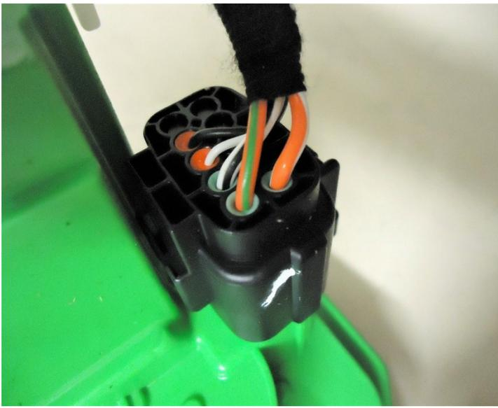
**N055 - MOTORIDUTTORE SERRATURA PORTA POSTERIORE SINISTRA (PORTA POSTERIORE SINISTRA)**
