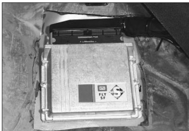
Fig. 28 Montaggio centralina nell'abitacolo
