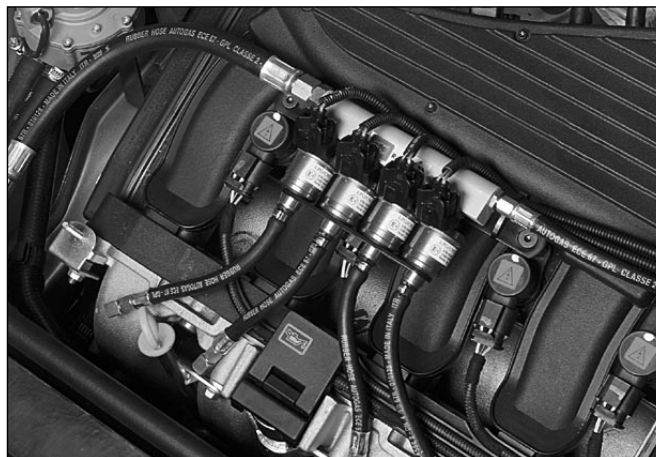
Fig. 15 Esempio installazione Rail con iniettori Keihin
