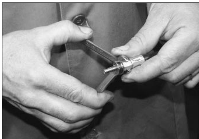
Fig. 25 Serraggio ugello su raccordo tubazione Solo per iniettori BRC
