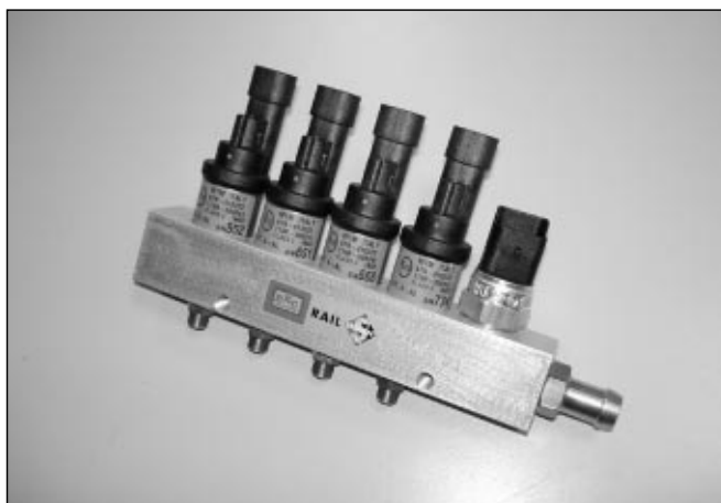
Fig. 18 Versione con iniettori BRC, sensore di pressione e temperatura gas e raccordo portagomma per applicazioni Sequent Fastness
