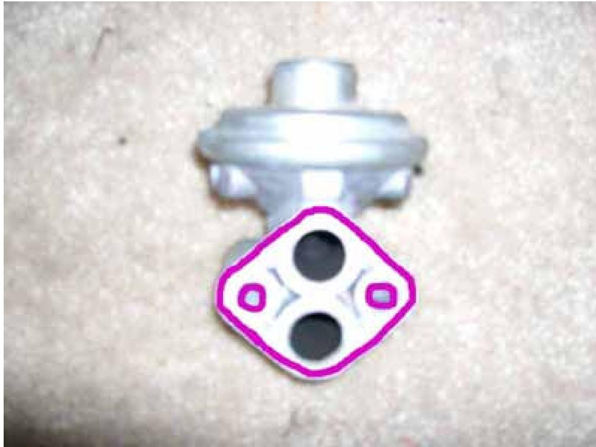
**Il tappo dovrà essere della stessa dimensione della guarnizione in acciaio che toglierete ( spessore della flangia max 2 mm, meglio se acciaio o alluminio). Solo che invece di farla forata, sarà tappata per impedire il passaggio dei gas di ricircolo. (perimetro viola)**
