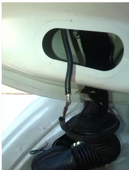
A questo punto non vi resta che trovare un cavetto nero, infilare un po di guaina termorestringente e saldarlo. La parte più complicata è ripassare il cavo dentro al tubo in gomma. Per fare ciò mi sono aiutato con un pezzo di plastica flessibile (una fascetta) che ho passato a mo di passacavi per poi legarci in coda il filo da passare.
