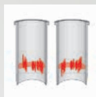
Segni di grippaggio dovuti al gioco sull'estremità inferiore del mantello 14
