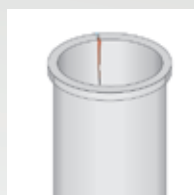
Cricche longitudinali nelle canne cilindro 65
