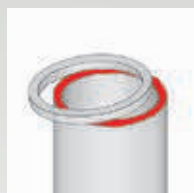
Collare della canna rotto sulla canna cilindro 66
