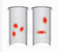
Usura non uniforme della superficie di scorrimento 70
