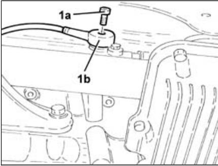
1. Svitare la vite (1a) e rimuovere il sensore di detonazione (1b).
