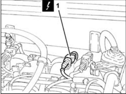
1. Scollegare la connessione elettrica del sensore di detonazione.
